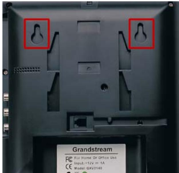
Figura 3: Montaje en la pared del GXV3140
