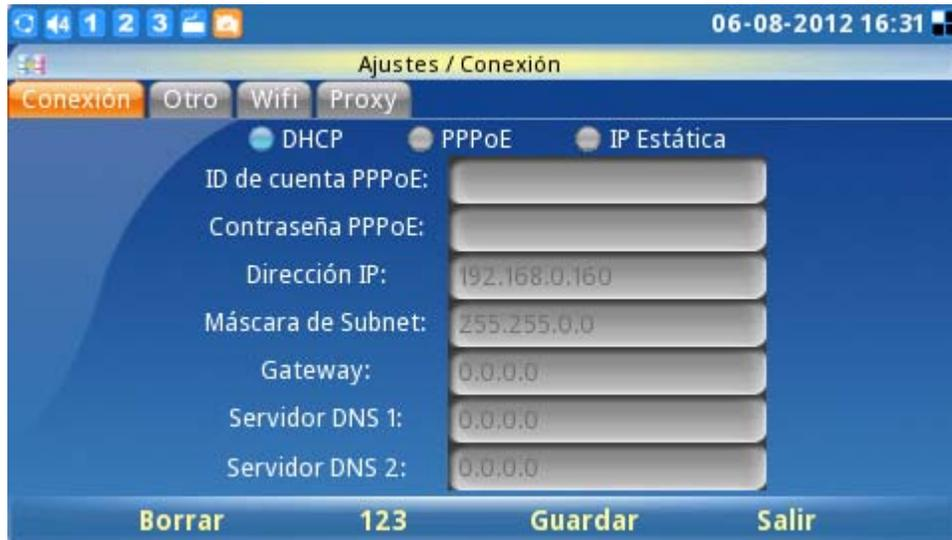
Figura 112: Configuración de la Red
