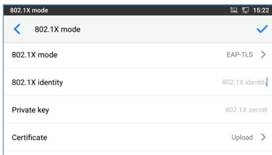
Figure 8: 802.1x mode (EAP-TLS)
