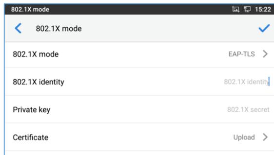
Figure 8: 802.1x mode (EAP-TLS)
