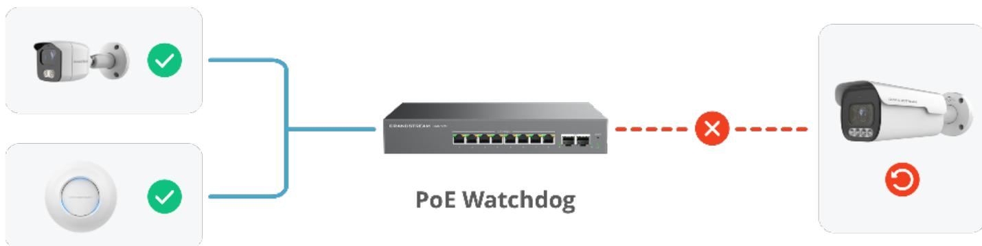
**Detección de anomalías:** El switch PoE monitorea continuamente el estado de funcionamiento de la red de los dispositivos conectados (como cámaras, AP, teléfonos IP, etc).
