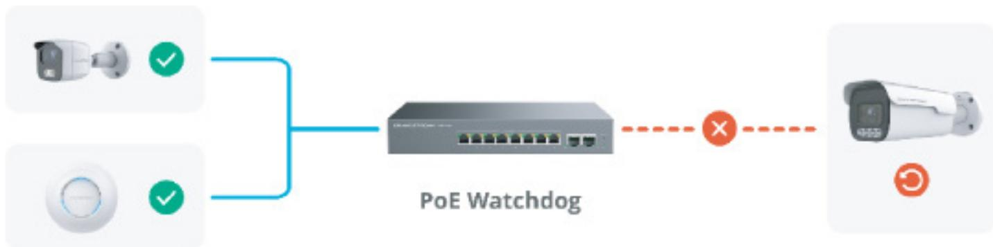
**Обнаружение аномалий:** коммутатор PoE постоянно отслеживает подключение питаемых устройств (например, камер, точек доступа, IP-телефонов и т. д.) к сети.
