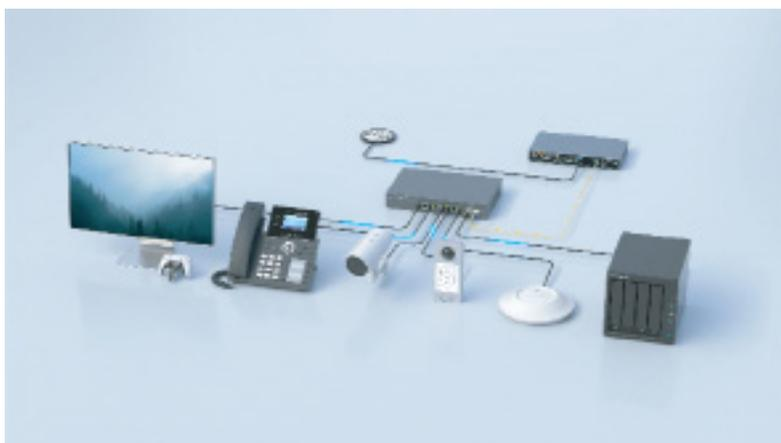
Каждый порт Ethernet обеспечивает питание PoE+ 802.3af/at до 30 Вт, а оптоволоконный порт поддерживает передачу данных со скоростью до 10 Гбит/с.
