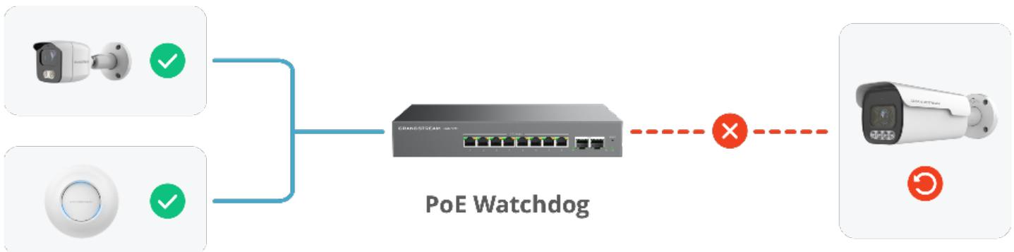
**Rilevamento delle anomalie:** Lo switch PoE monitora continuamente lo stato di funzionamento della rete dei dispositivi alimentati collegati (come telecamere, AP, telefoni IP, ecc.).
