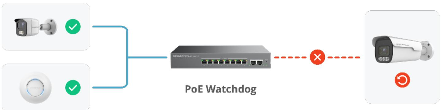
**Erkennung von Anomalien:** Der PoE-Switch überwacht kontinuierlich den Betriebsstatus der verbundenen Geräte (z. B. Kameras, ZPs, IP-Telefone usw.) im Netzwerk.
