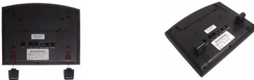
Bild 2: Anbringen der Abstandshalter am GXP2020
