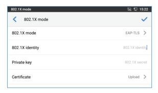
Figure 8: 802.1x mode (EAP-TLS)
